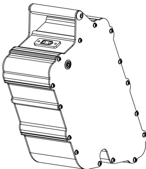
El pack se fabrica en base a celdas de litio ION 21700 en formato cilíndrico, con una configuración 12S4P.
